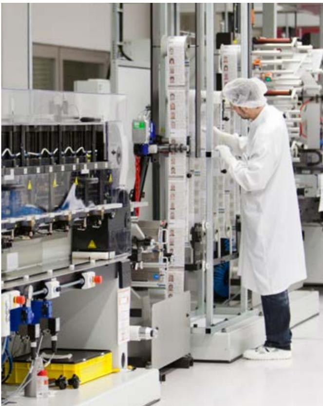
An der Laminationsmaschine werden die verschiedenen Schichten des neuen Personalausweises zusammengeführt.
